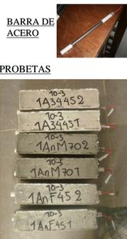
Se fabricaron un total de 72 probetas de hormigón, cada una de ellas con una barra de acero en su interior. Se contempló el uso de 6 tipos de conglomerantes y 3 razones agua/congl diferentes. Estas probetas fueron sometidas a un ensayo acelerado de corrosión por cloruros y simultáneamente fue evaluado el grado de corrosión en las mismas.
